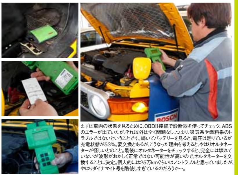
まずは車両の状態を見るために、OBDII接続で診断器を使ってチェック。ABSのエラーが出ていたが、それ以外は全く問題なしつまり、吸気系や燃料系のトラブルではないということです。統いてバッテリーを見ると、電圧は足りているが充電状態が53%。要交換となるが、こうなった理由を考えると、やはりオルタネーターが怪しいとのこと。最後にオルタネーターをチェックすると、完全には壊れていないが波形がおかしく正常ではない可能性が高いので、オルタネーターを交換することに決定。個人的には25kmくらいはノントラブルと思っていたが、やはりダイナマイト号を酷使しているのだろうか…。
