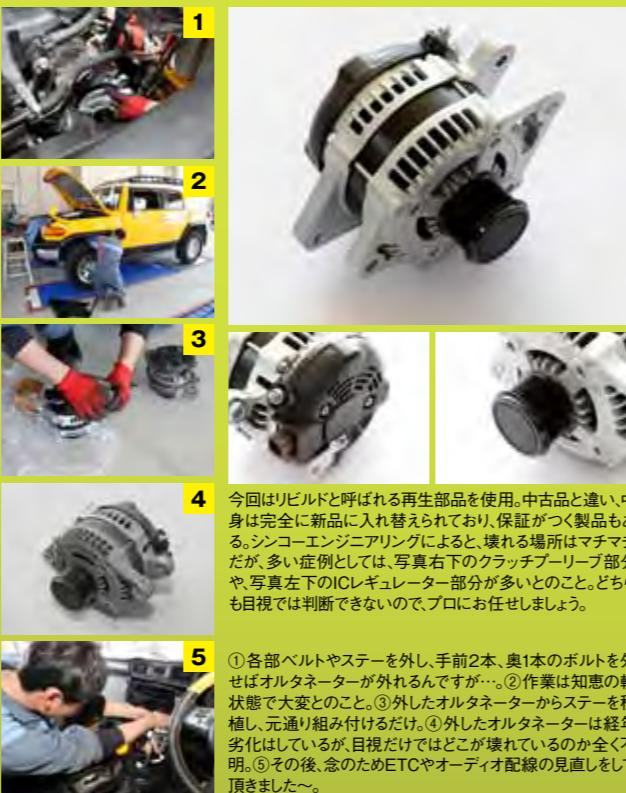
①各部ベルトやステーを外し、手前2本、奥1本のボルトを外せばオルタネーターが外れるんですが…。②作業は知恵の輪状態で大変とのことです。③外したオルタネーターからステーを移植し、元通り組み付けるだけ。④外したオルタネーターは経年劣化はしているが、目視だけではどこが壊れているのか全く不明。⑤その後、念のためETCやオーディオ配線の見直しを頂きました。
