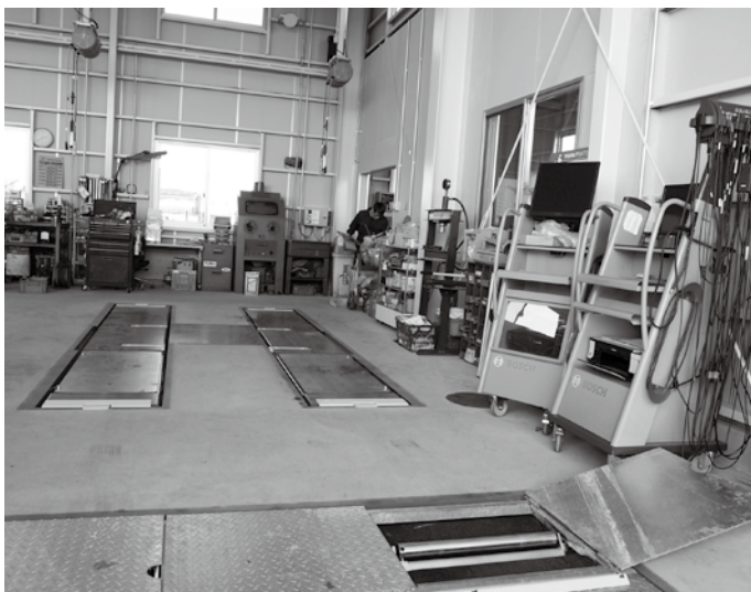
ボッシュの診断機を設備。サスペンションテスターとブレーキテスト。足回り整備に力を注ぐ。将来的には四輪アライメントテスターの導入も視野に入れる。
